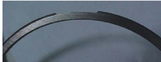
Fig. 3.4.2 Chipped contact face
